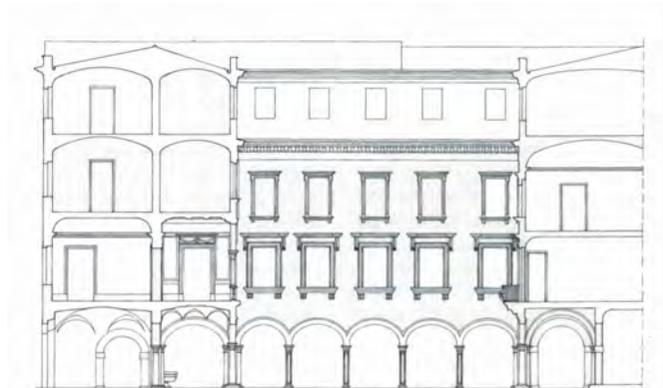
Fig.20 *Sezione della corte di Palazzo Mazzarino* (rilievo da F. Scaduto, 2000).
